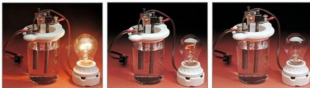
Рис. 23. Приборы для измерения электропроводности веществ Какие вещества испытывали на электропроводность?
